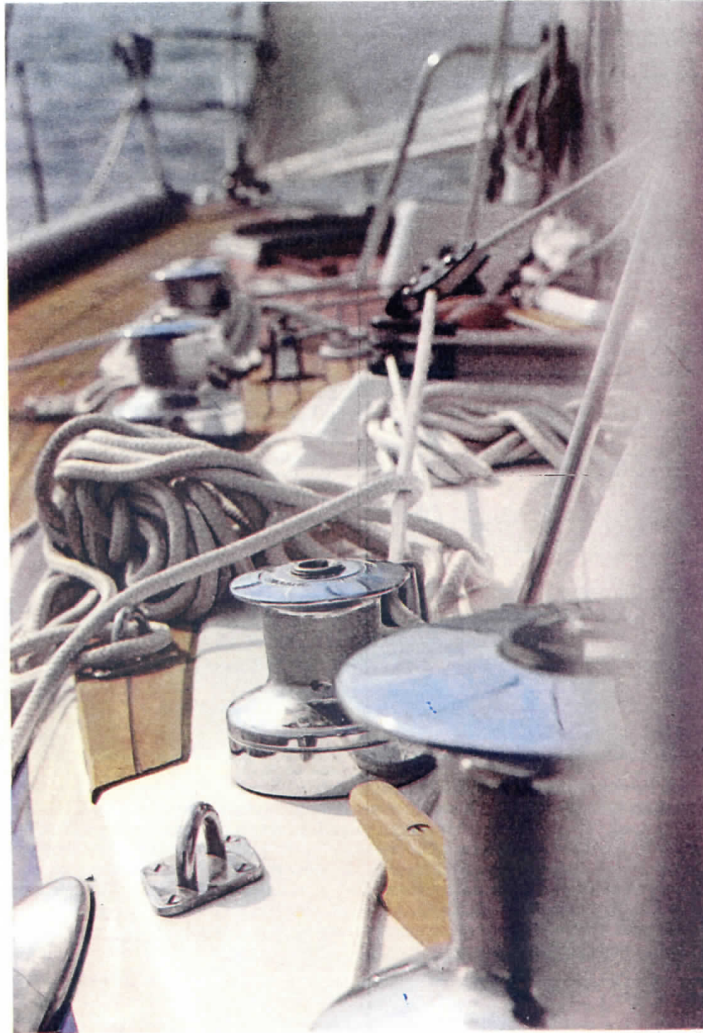
Une batterie de winches disposée en ligne de chaque côté du rouf en sifflet.
